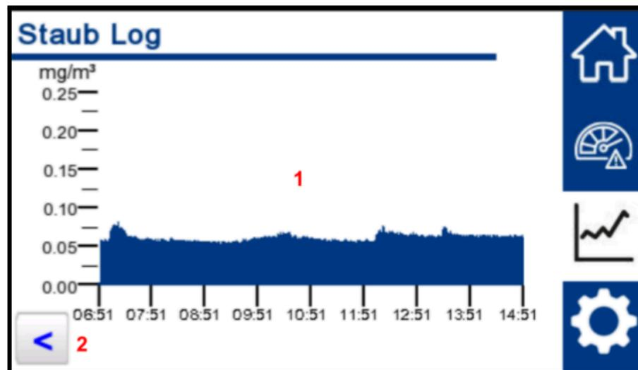
**1:** Das Diagramm zeigt die Staubkonzentration in Abhängigkeit zur Zeit. Abgebildet werden die gemessenen Werte der letzten 8 Stunden. Die Höhe der Y-Achse orientiert sich an dem oberen roten Grenzwert für Staub, siehe Menü "Grenzwerte".
